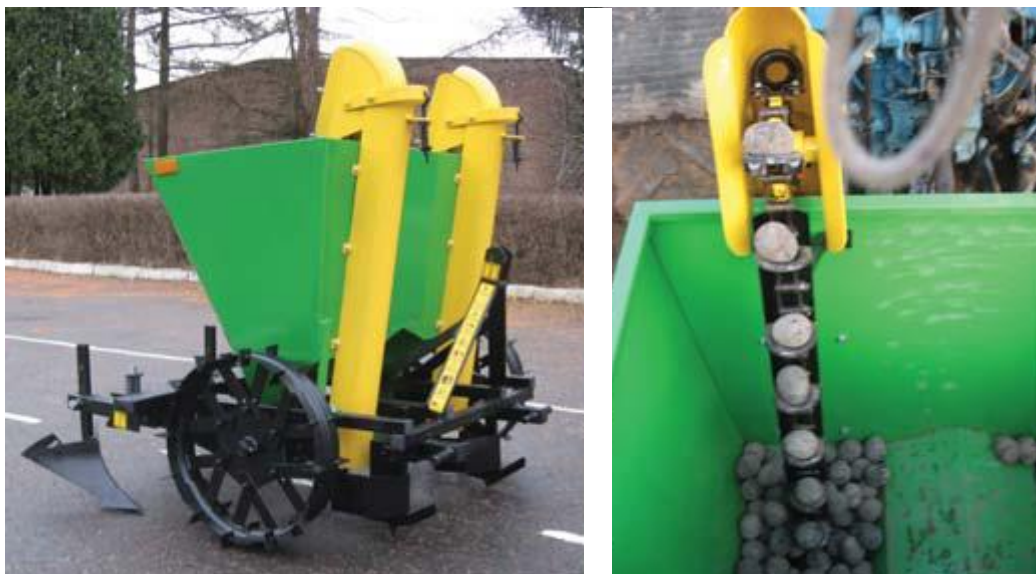
Рисунок 1.3 – Картоплесаджалка з ланцюгово-ложечковим садильним апаратом: a – картоплесаджалка КСН-2Л, б – ланцюгово-ложечковий садильний апарат.
