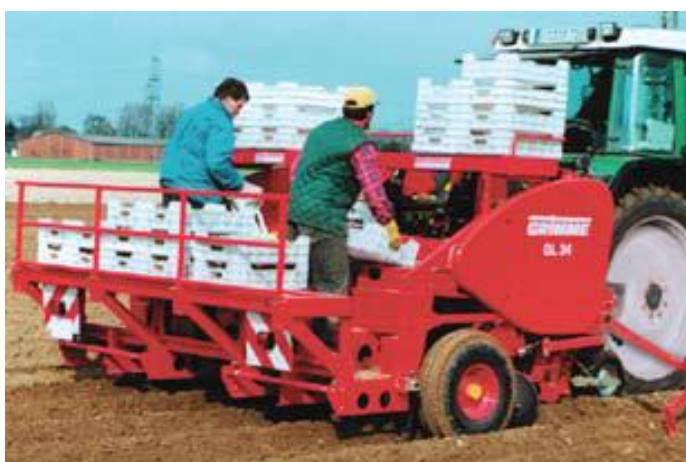
Рисунок 1.4 – Картоплесаджалка GL-34К для садіння пророщених бульб: a – картоплесаджалка (загальний вигляд), б – конструктивна схема картоплесаджалки.
