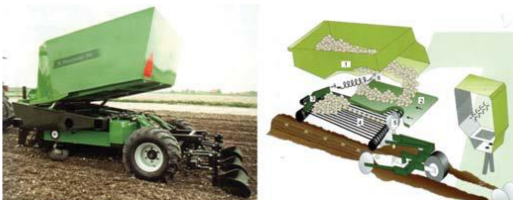
Рисунок 1.5 – Картоплесаджалка типу Structural 20: а – загальний вигляд, б – конструктивно-технологічна схема картоплесаджалки.
