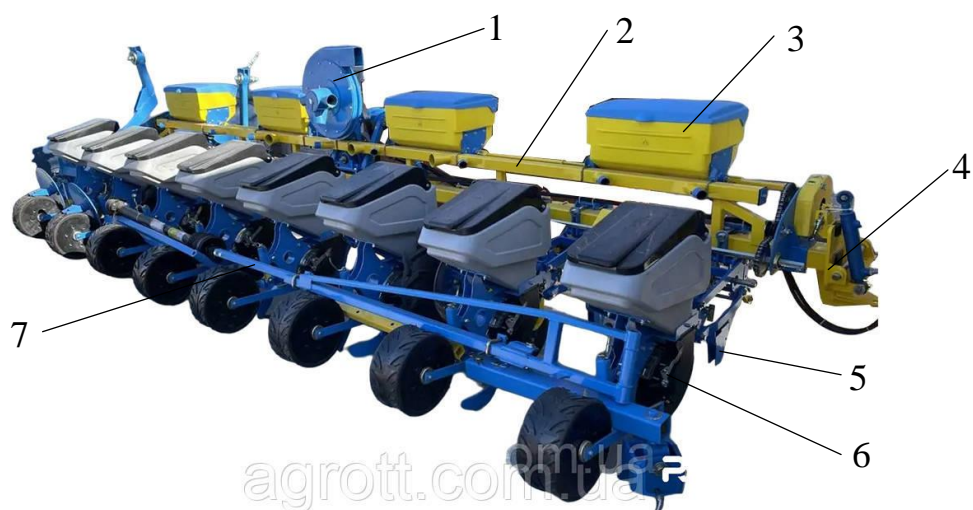
Рисунок 1.2 – Пневматична начіпна сівалка УПС-8: 1 – вентилятор; 2 – рама; 3 – туковисівний апарат; 4 – причіпний пристрій; 5 – сошник для добрив; 6 – посівна секція; 7 – маркер.
