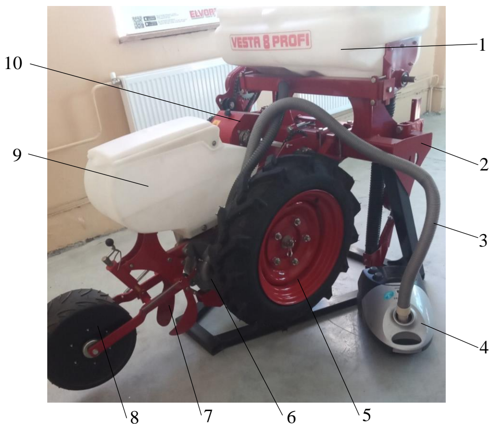
Рисунок 3.1 – Лабораторна установка на базі робочої секції сівалки VESTA-8 PROFİ для дослідження параметрів роботи висівного апарату:
