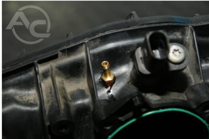
Рис. 3.8. Сопло розрідження, встановлене в колекторі
