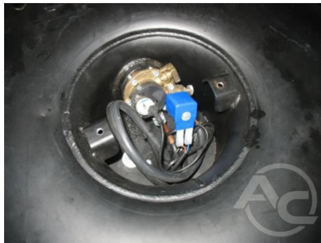
Рис. 3.4. Зовнішній вигляд балона та підключеного мультиклапана
