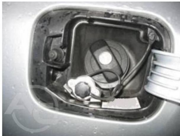
Рис. 3.3. Заправний клапан в поглибленні заливного отвору бензину
