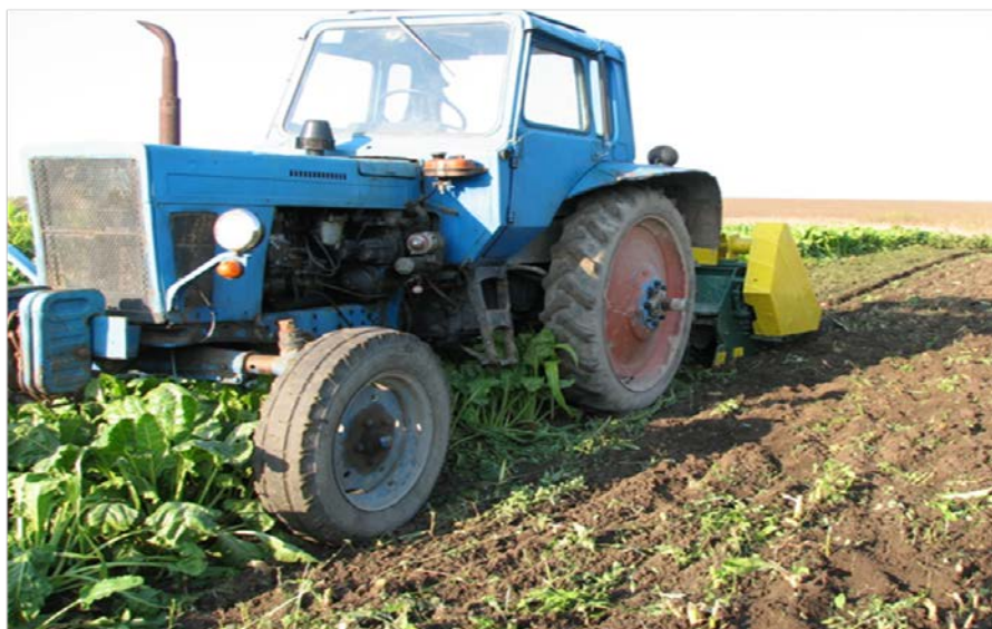
Рисунок 3.4 - Загальний вигляд гичкозбирального агрегату під час польових випробувань
