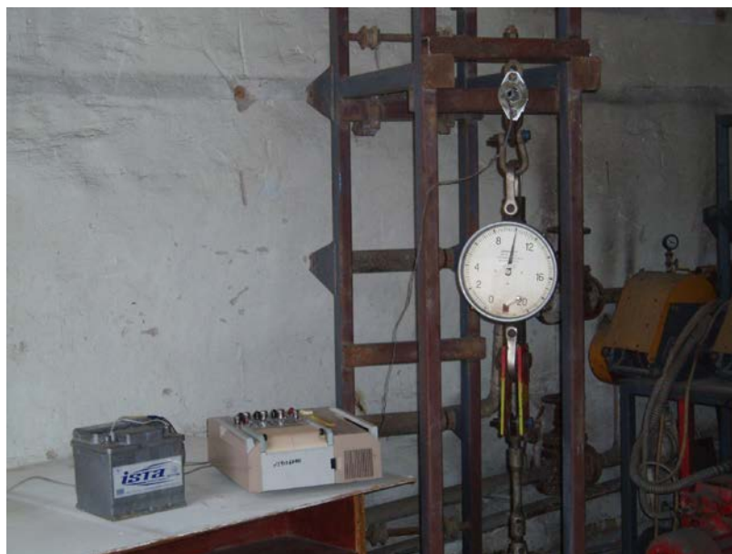
Рисунок 4.3 - Тарувальний стенд для тарування механічного динамометра
