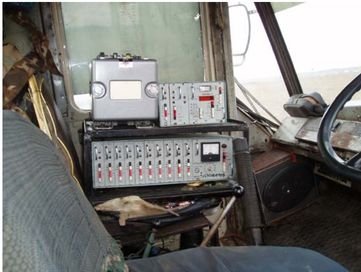
Рисунок 4.2 – Обладнання для фіксації зміни навантажень на навісці трактора.
