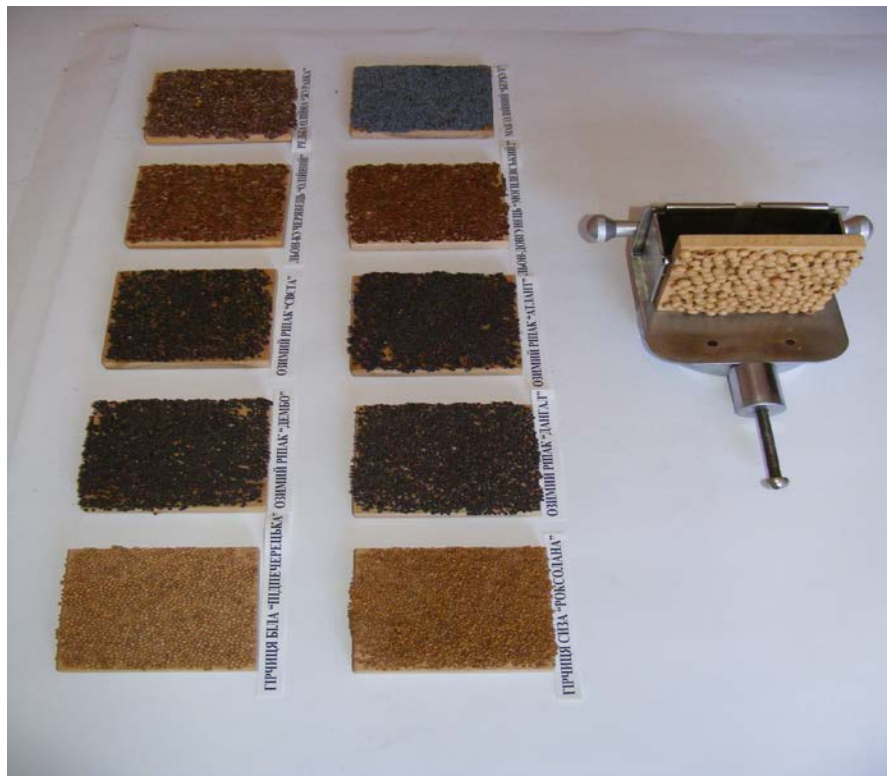
Рисунок 3.4 - Вигляд кріплення дослідних зразків.
