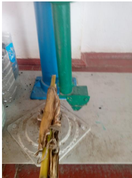
Рисунок 3.4 - Лабораторна установка копрового типу, для визначення зусилля перерізання стебла кукурудзи
