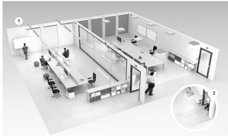
Рисунок 1.1 – Поділ приміщення на зони освітлення
