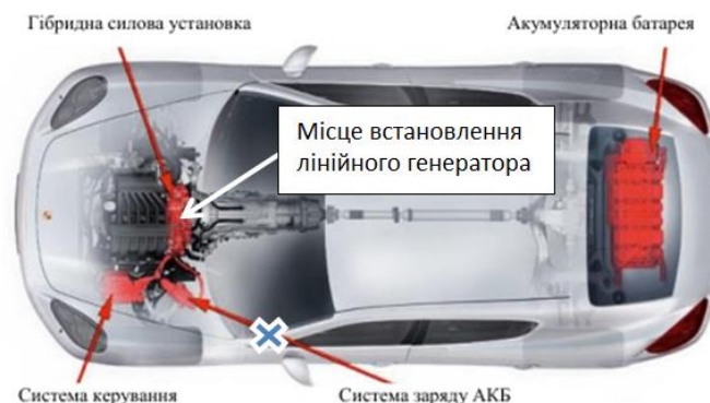
Рисунок 3.2 – Модернізована енергетична установка гібридного (електричного) автомобіля.
