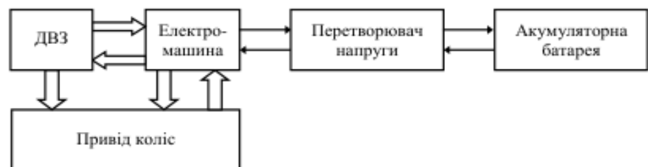
Рисунок 3.1 – Структурна схема енергетичної установки з використанням лінійного генератора, потужністю 12кВт.
