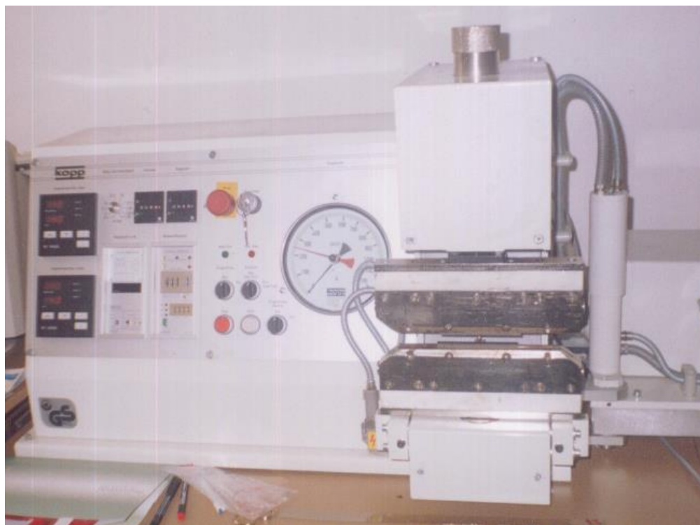
Рисунок 1.2. – Загальний вигляд приладу для налаштування режиму термічного зварювання полімерних плівок
