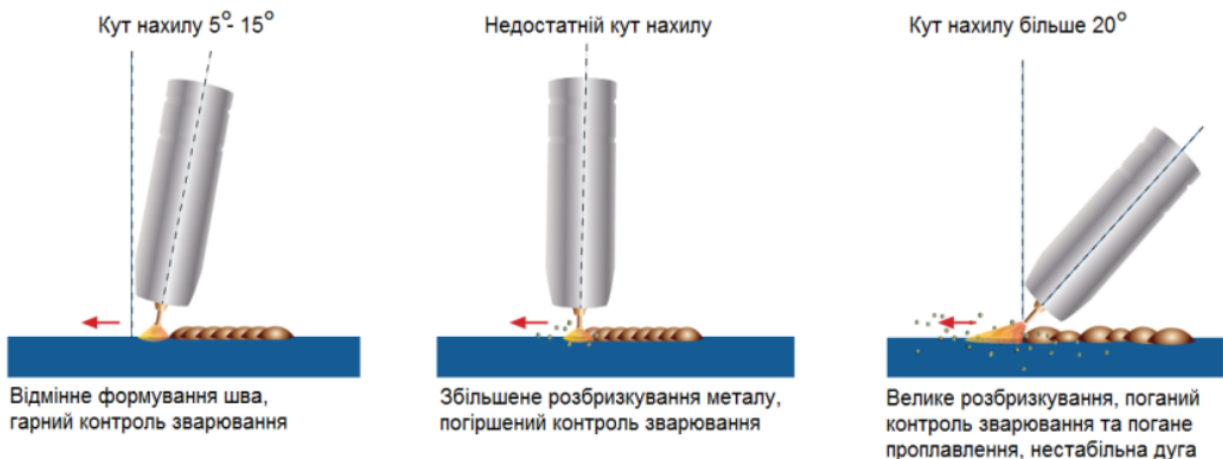
Рисунок 1.10 – Приклад впливу нахилу пальника на якість зварювання
