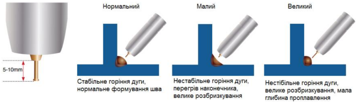
Рисунок 1.7 – Приклад впливу вильоту дроту на формування шва
