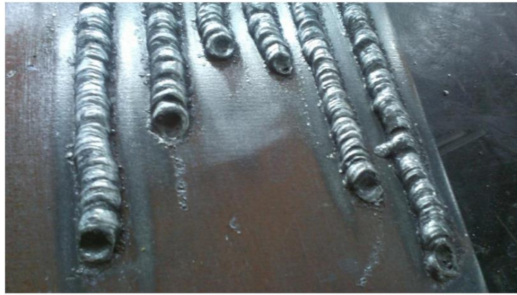
Рисунок 2.5 - Розплавлення «голих» (оббитих) електродів частинами у співвідношенні 1/3 і 2/3 від повної довжини та цілого електрода
