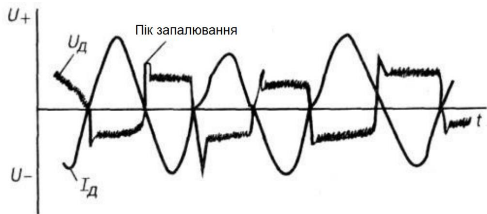
Рисунок 1.5 - Форми струму та напруги дуги змінного струму
