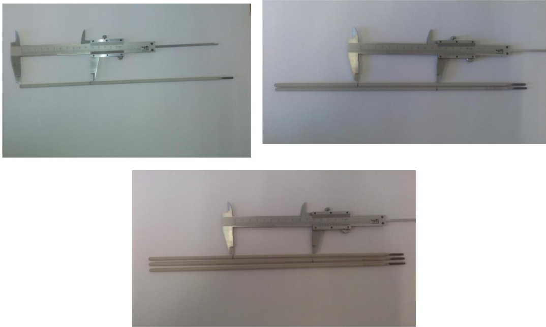
Рисунок 2.3 - Розмітка електродів у співвідношенні 1/3 та 2/3 від повної довжини
