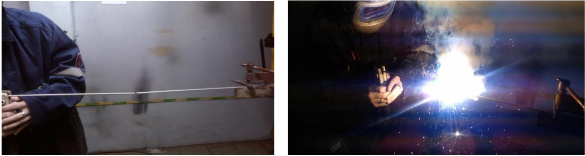
Рисунок - 2.10. Запалювання та горіння дуги у дослідах із дугою непрямої дії
