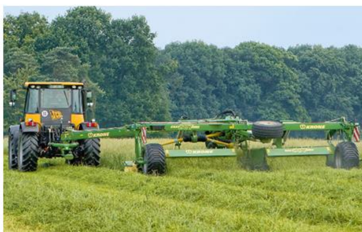
Рисунок 1.5 – Косарка причіпна Eusy Cut 6210 (фірма KRONE)
