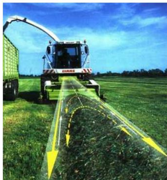
Рисунок 1.11 – Самохідний кормозбиральний комбайн Jaguar 850 (фірма Claas)
