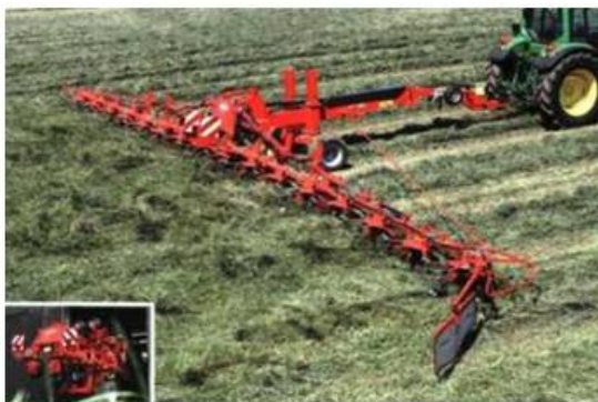
Рисунок 1.6 – Ворушилка FG 17002 (фірми Kuhn)
