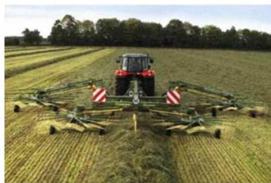
Рисунок 1.7 – Валкоутворювач Swardo 1400 (фірми KRONE)
