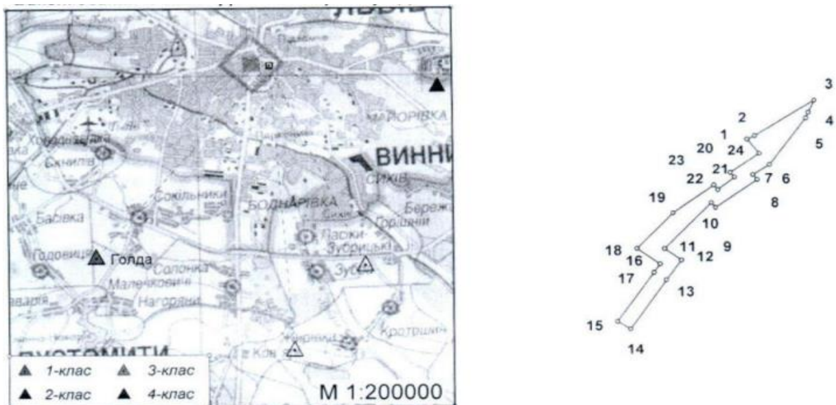
Рис. 3.1. – Вкопювання із схеми Державної геодезичної мережі для об'єкта дослідження.
