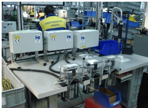
Рисунок 1.5 - Пристрої для згинання клем і пневматична викрутка
