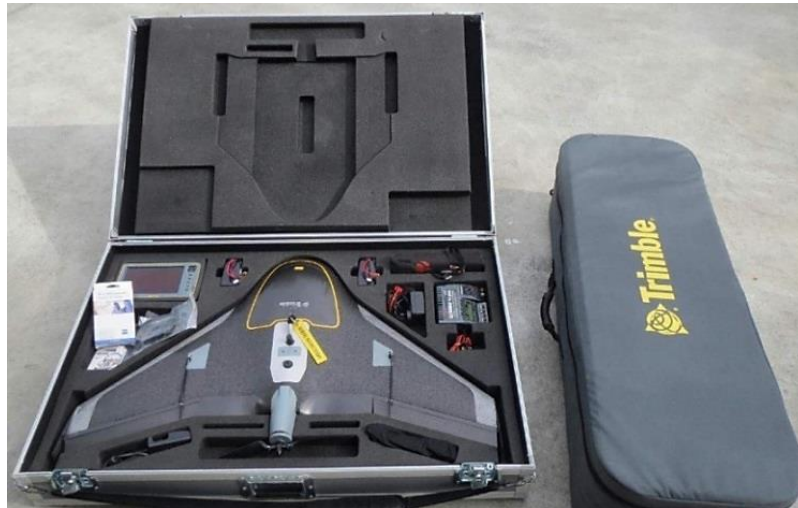
Рисунок 2.3. – Комплектація БПЛА та катапульти
