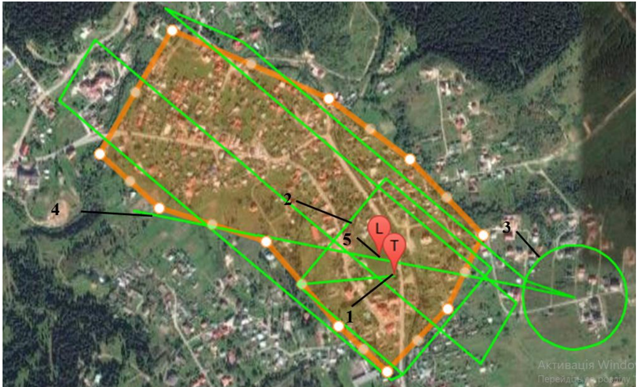
Рисунок 2.5. – Побудова маршруту аерознімання на територію с.Східниця де: 1 – місце старту, 2 – коробка набору висоти, 3– коло зниження, 4 – місце відкриття парашуту, 5– місце приземлення
