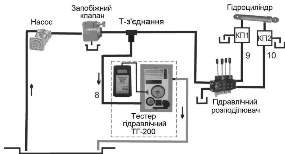
Рисунок 3.6 – Тестування за допомогою Т-з'єднання
