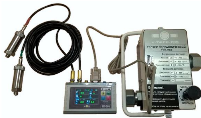
Рисунок 3.7 - Електронна модифікація тестера ТГЕ-200
