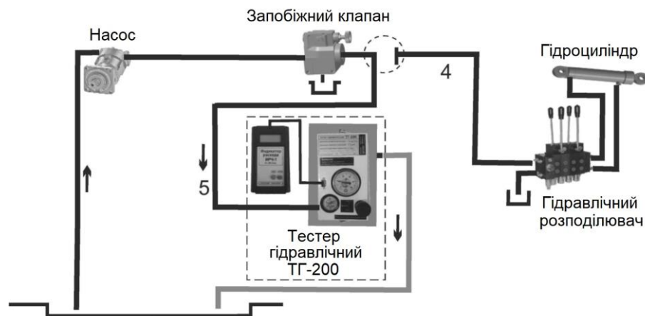
Рисунок 3.4 – Схема тестування запобіжного клапана
