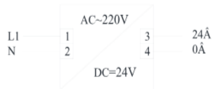
Рис.2.10. Схема підключення блоку живлення БП-30-1к-24
