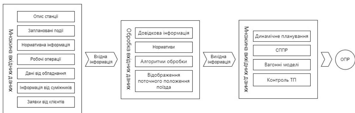
Рисунок 3.4 - Обробка даних програмно-апаратним комплексом і передача оператору
