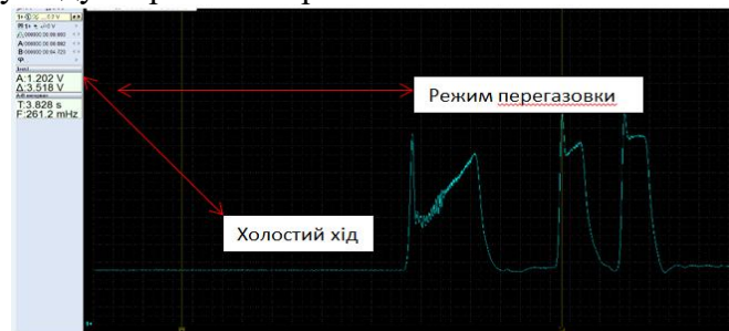
Рис. 3. Форма вихідних електричних імпульсів ДМВП.
