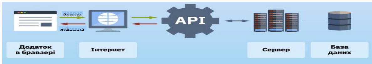
Рис. Схема алгоритму GET-запиту клієнта до сервера з метеоданими
