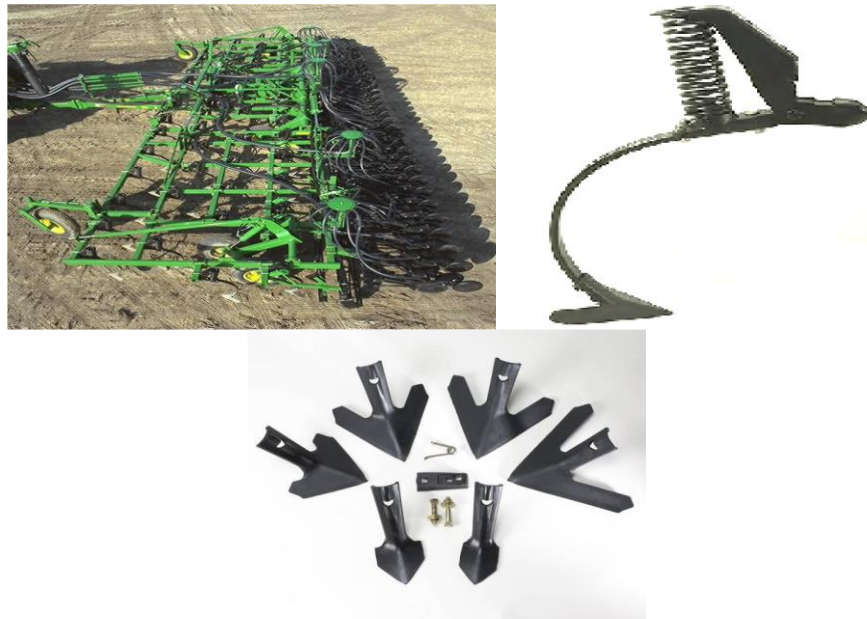
Рис. 2. Культиваторна лапа сівалки
