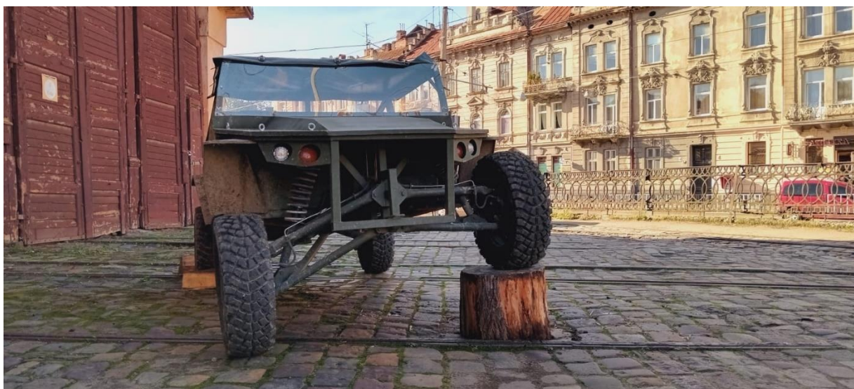
Рис. 1. Довгоходова передня підвіска легкого ударного автомобіля „Мамай”
