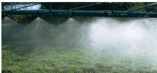
Рис. 1. Інжекторні (ліворуч) та щілинні (праворуч) розпилювачі в роботі
