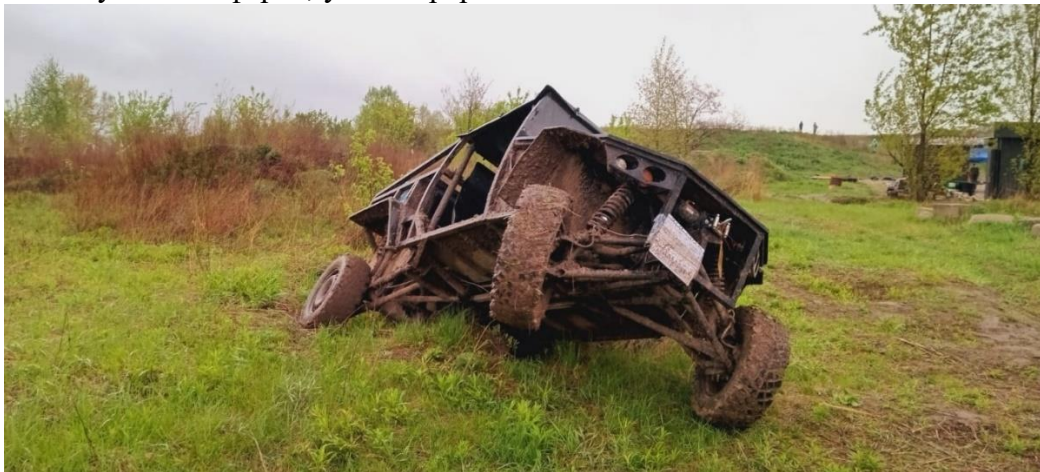
Рис. Незалежна довгоходова підвіска на здвоєних поперечних та поперечно-діагональних важелях (військове баггі ТУР KB 02 «Мамай»).
