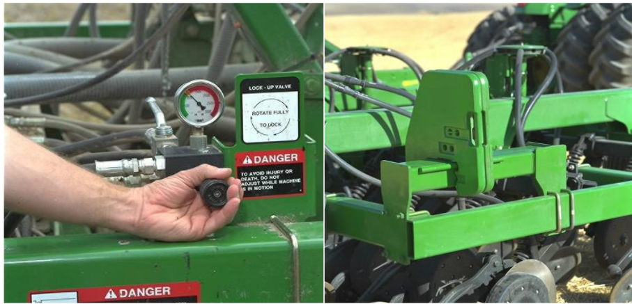
Рис. 3. Регулятор гідравлічного блокування та системи механічного довантаження сошників
