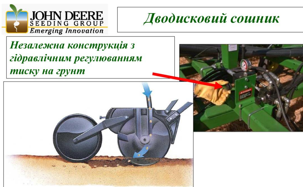
Рис. 1. Система регулювання притискного зусилля на ґрунт сошника
