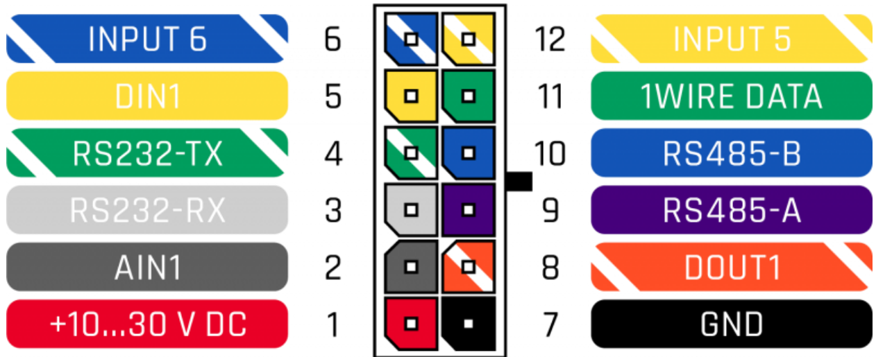
Рис. 3.2 Схема розташування виводів FMB125
