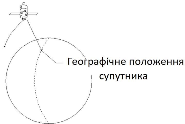
Рисунок 1.4 – Схема географічного положення супутника
