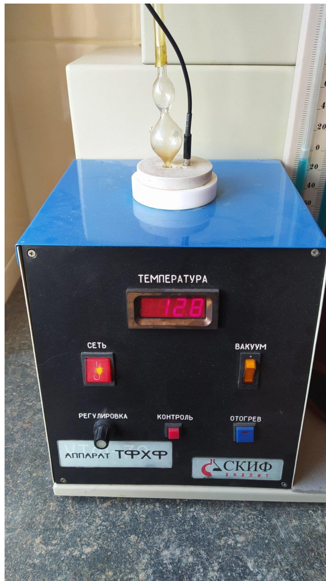
Рисунок 3.12 - Процес тарування сенсора температури DS18B20
