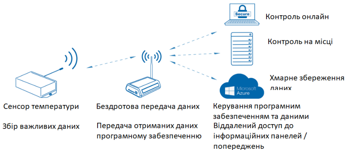
Рисунок 1.7 Схема роботи сенсора температури
