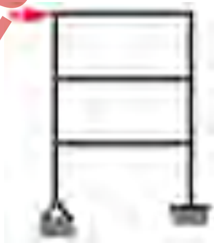
Рисунок 3.4 – Рама, змодельована з балкових елементів
