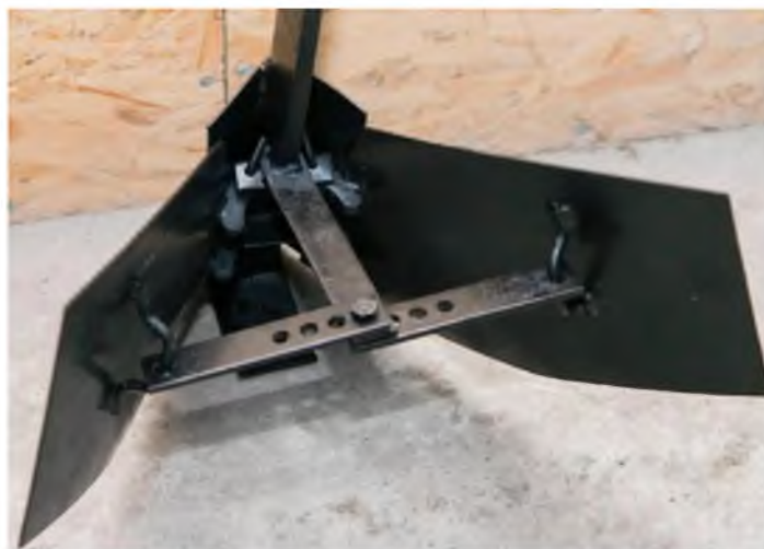
Рис. 2.10 - Підгортач з регульованою шириною підгортач
