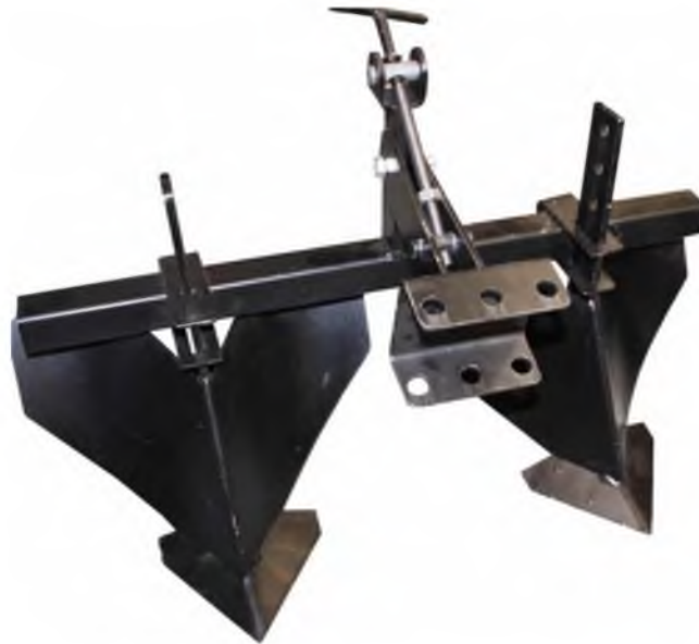
Рис. 2.9 - Лістерний (з фіксованою шириною) підгортач
