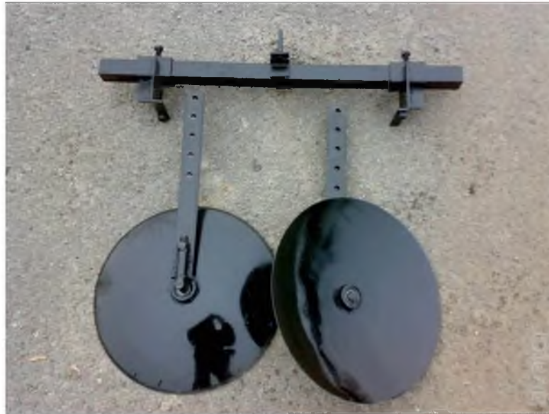
Рис. 2.10 - Підгортач з регульованою шириною дисковий
