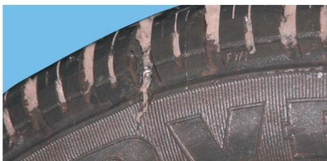
Рисунок 1.1 – Наскрізний проріз шини [13]
