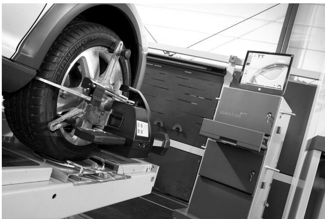
Рисунок 1.7 – Кріплення вимірювальні головки до керованих коліс
