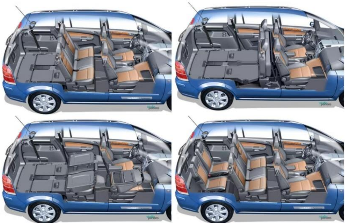
Рисунок 3.1– Схема складання та розкладання сидінь третього ряду автомобіля Opel Zafira B.
