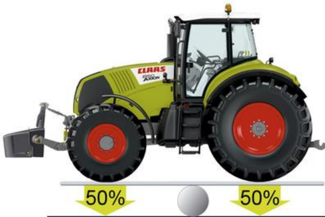
Рисунок 1.10 – Схема розподілу ваги трактора CLAAS AXION 820 / 850
