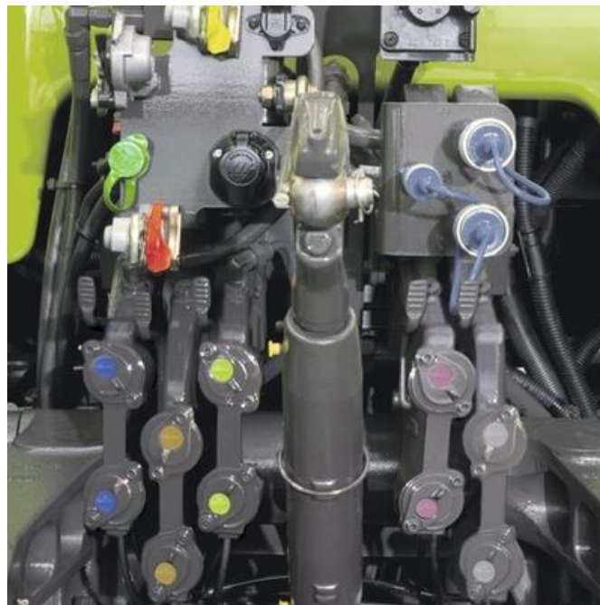
Рисунок 1.13 – Загальний вигляд гідравлічної системи трактора CLAAS AXION 820 / 850
