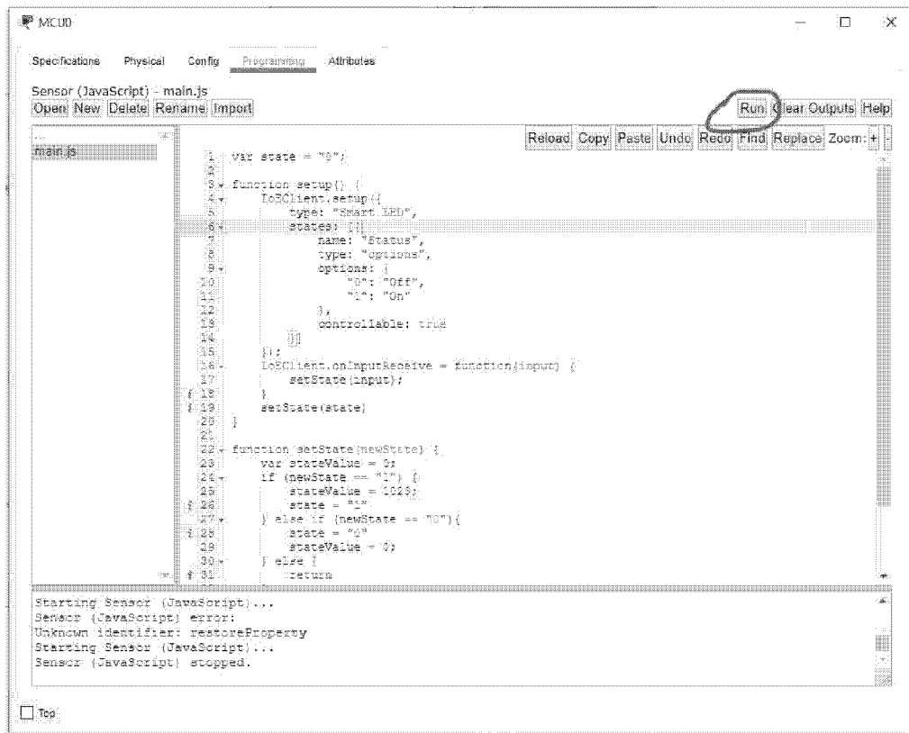
Рисунок 3.8 – Вкладка MCU з кодом програми керування
