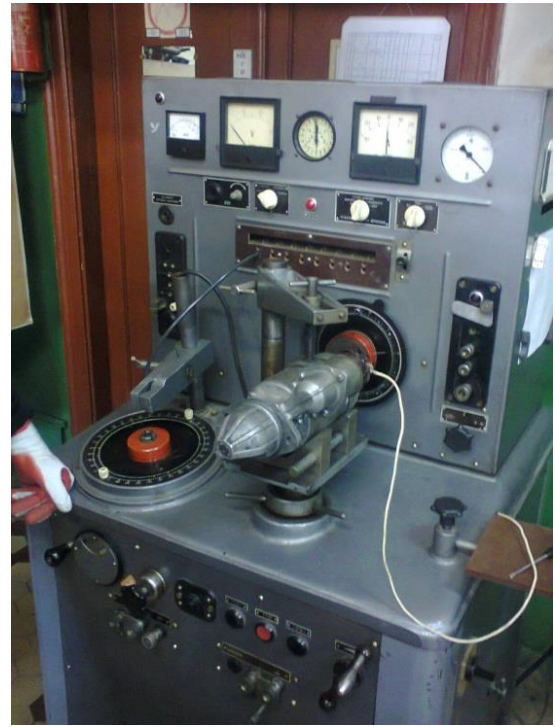
Рисунок 1.2 – Розташування органів керування контрольно-вимірювального станда КИ-968 У4: 1 – затискачі з перекидною планкою перемикачів акумуляторної батареї; 2 – ручка ввімкнення синхрографа; 3 – переривник станда; 4 – вакуумний насос; 5 – синхрограф; 6 – високовольтний вивід еталонної котушки запалювання; 7 – кнопка ввімкнення кола перевірки конденсаторів; 8 – затискач для під'єднання конденсаторів; 9 – гніздо "переривник – розподільник"; 10 – гніздо "батарея"; 11 – гніздо "переривник станда"; 12 – вихідні гнізда вольтметра; 13 – гніздо "синхрограф"; 14 – ручка повзуна регульовального реостата "max–min"; 15 – кнопка вмикання вимірювача кута замкнутого стану контактів переривника–розподільника; 16 – ручка встановлення "0" мікроамперметра; 17 – мікроамперметр вимірювача кута замкнутого стану контактів; 18 – вольтметр; 19 – перемикач режимів вольтметра; 20 – сигнальна лампа ввімкнення станда в електричну мережу; 21 – сигнальна лампа ввімкнення акумуляторної батареї; 22 – тахометр; 23 – амперметр; 24 – перемикач випробування приладів запалювання; 25 – перемикач шунтів амперметра; 26 – вакуумметр; 27 – ручка повзуна навантажувального реостата; 28 – ручка регулювання зазору іскророзрядника; 29 – лінза контрольної лампи 220 В, 60 Вт.; 30 – кронштейн
