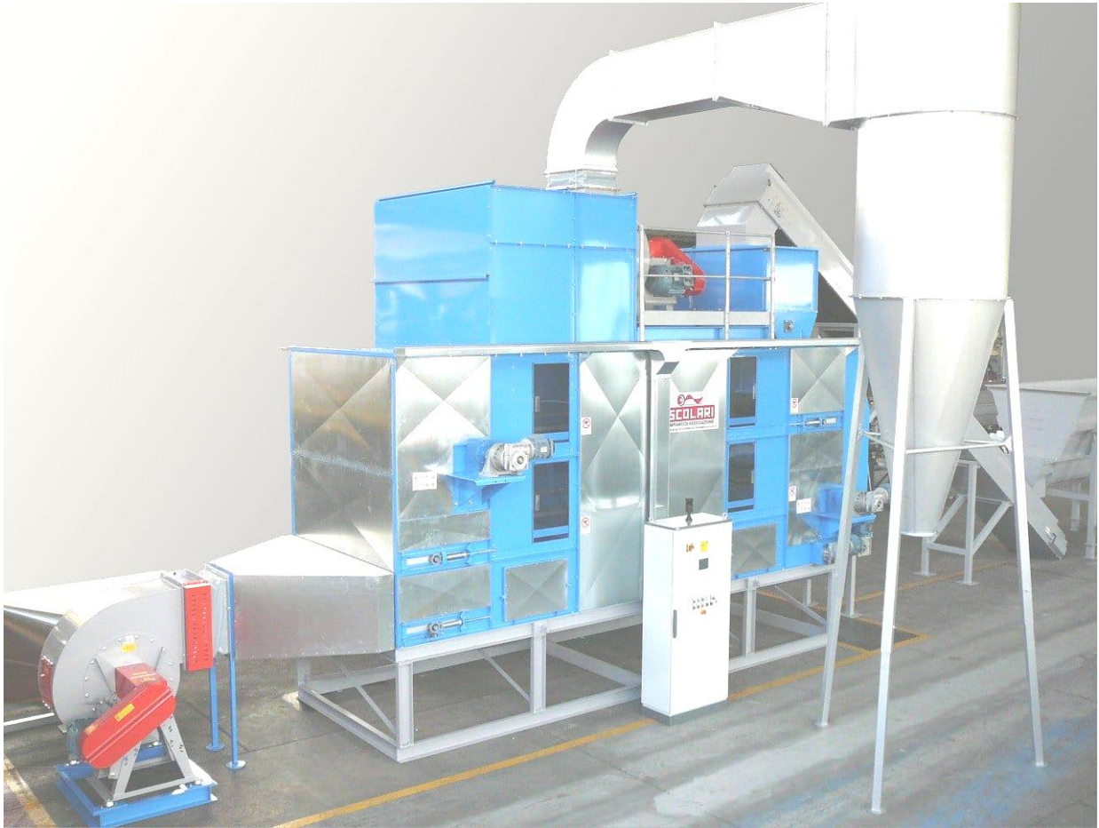
Рис. 1.3 – Робоча частина конвеєрної сушарки Scolari [7]
