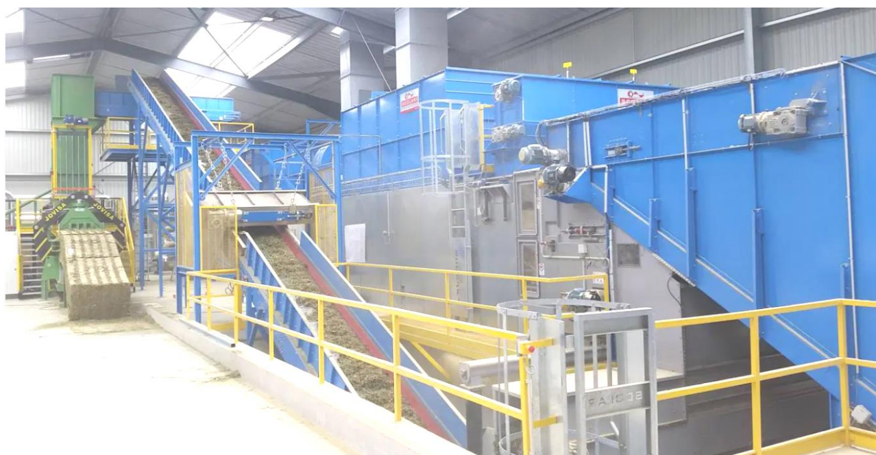
Рис. 1.5 – Система подачі сировини конвеєрною сушаркою Scolari [7]
