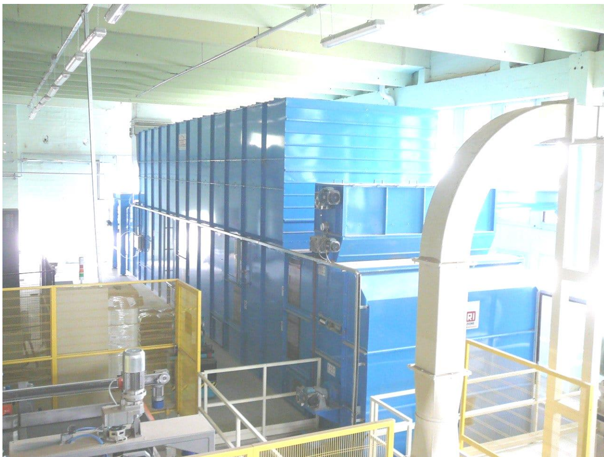
Рис. 1.4 – Модульна конструкція сушарки Scolari [7]
