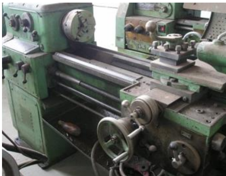
Рисунок 1.3 - Токарний верстат 1К62
