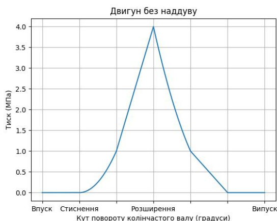
Рисунок 2.2 - Індикаторна діаграма без турбокомпресора
