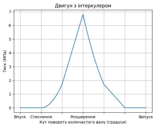
Рисунок 3.9 - Індикаторна діаграма двигуна з інтеркулером
