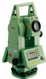
Рисунок 3.3.5 - Зображення приладу Leica TCR 805 ultra
