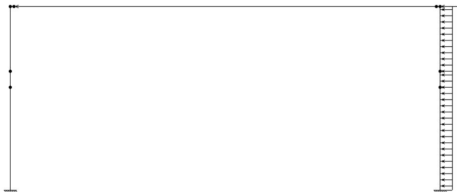
Рис. 2.10 Схема вітрового навантаження на раму (вітер справа)
