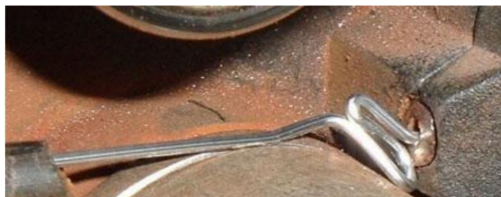
Рисунок 2.8 – Змінання алюмінієвого дроту у механізмі подачі
