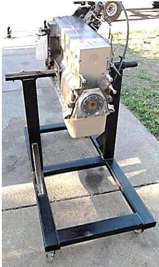
Рисунок 2.8 – Оснащення для закріплення і обертання рядного двигуна під час ремонту.
