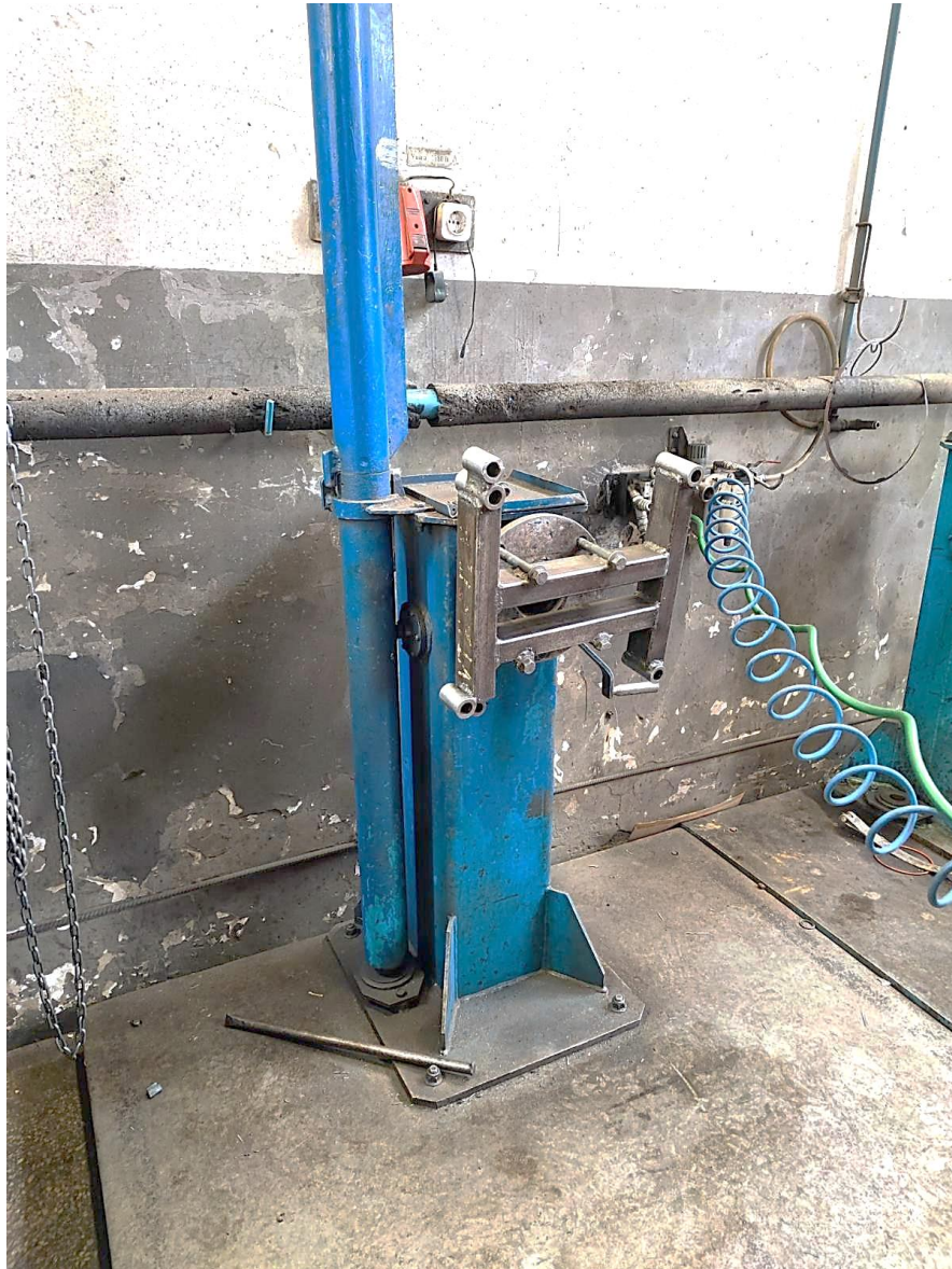
Рисунок 4.4 – Загальний вигляд станда оснащеному електричним тельфером на поворотній консолі і системою подачі стисненого повітря для живлення пневматичного гайкокрута
