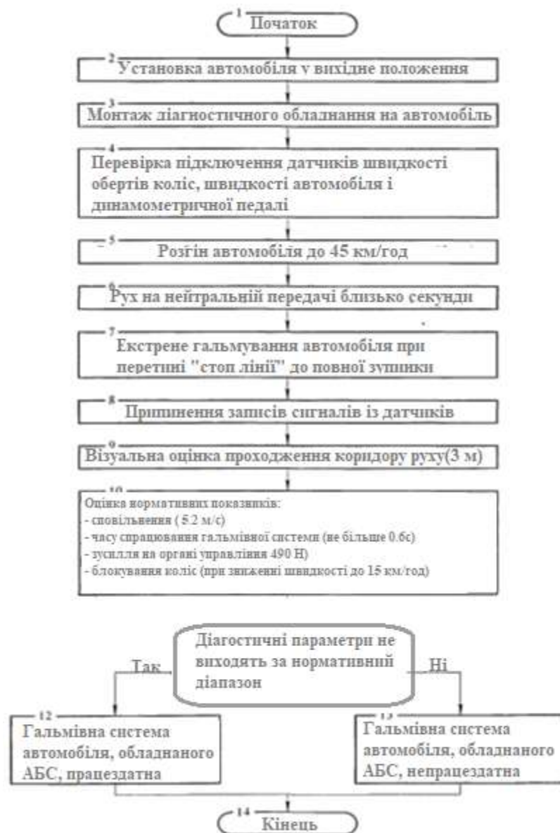
Рисунок 3.2 – Алгоритм оцінки працездатності гальмівної системи, обладнаної АБС
