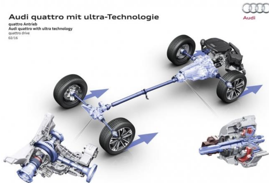
Рисунок 1.4 – Конструкція осьових та міжосьових диференціалів за технологією «Audi quattro»
