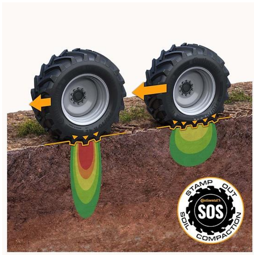
Рисунок 1.2 – Тиск рушія на опорну поверхню
