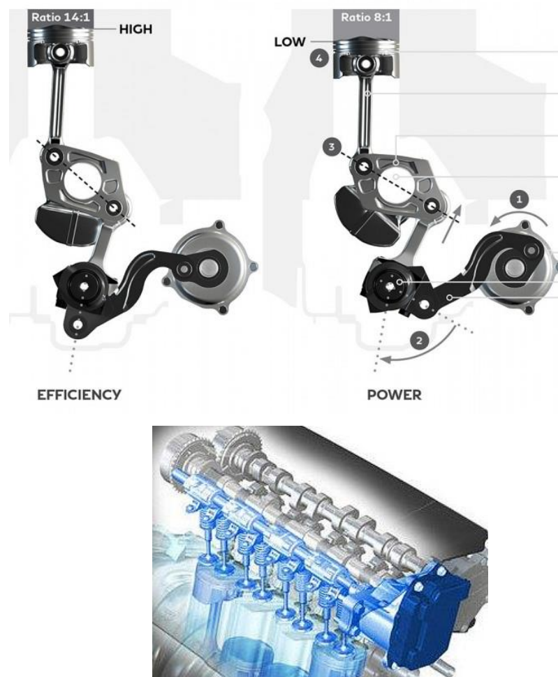
Рисунок 1.3 – Реалізація технологій за циклом Міллера
