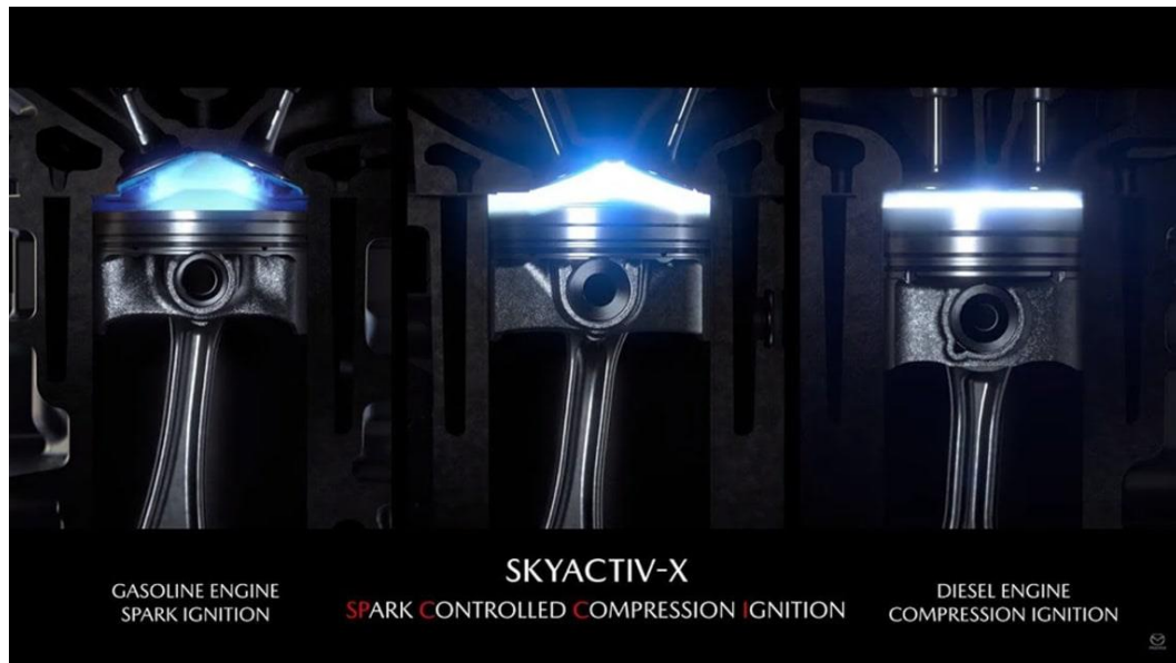
Рисунок 1.2 – Збільшення ступеня стиску за технологією Skyactiv-X
