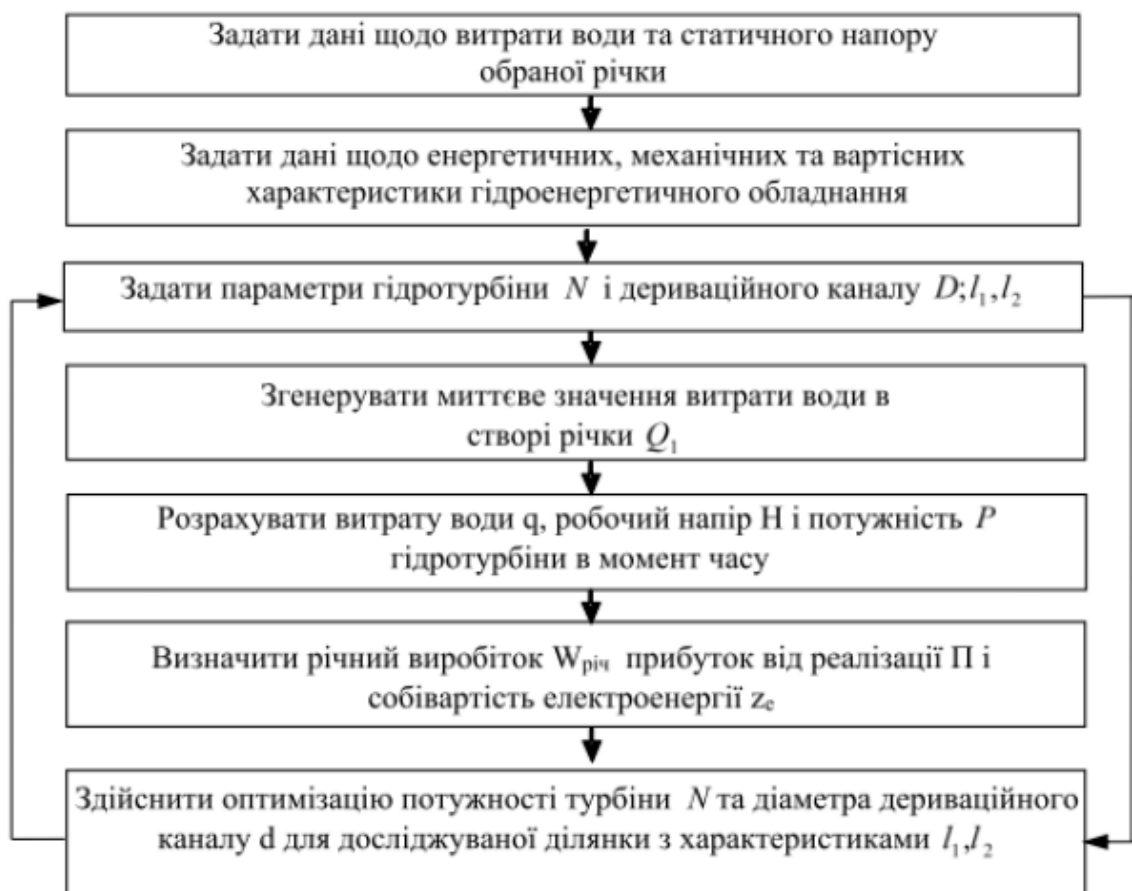
Рисунк 12 – Укрупнена схема алгоритму дослідження системи з використанням статистичного імітаційного моделювання
