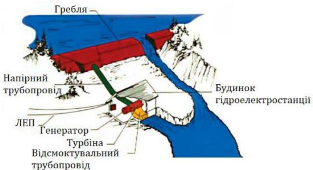
Рисунок 8 – Схема типової гідроелектростанції
