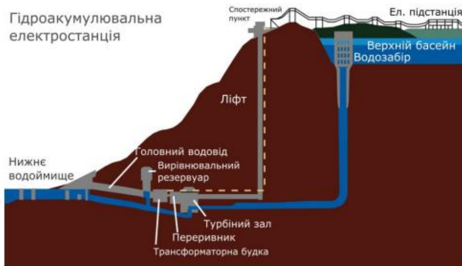
Рисунок 4 – Гідроакумулювальна електростанція у розрізі [28]
