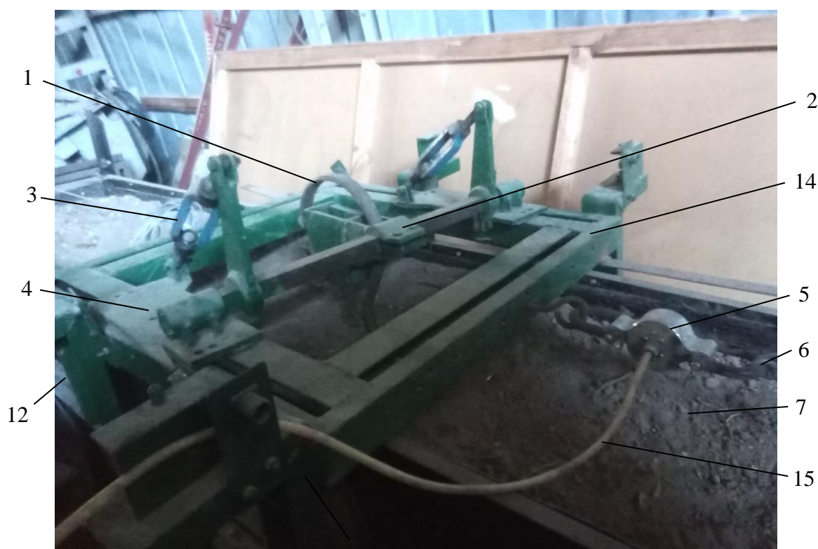
Рисунок 3.1 Лабораторна установка для дослідження опору стрілочасті лапи культиватора POLARIS 10 PREMIUM:
