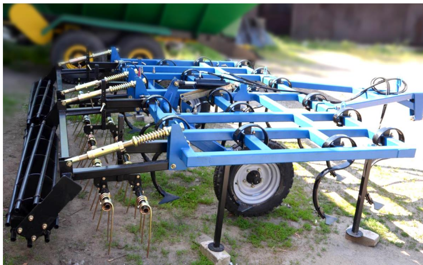
Рисунок 1.3 – Культиватор КПС-4 причіпний з універсальними стрілочастими лапами
