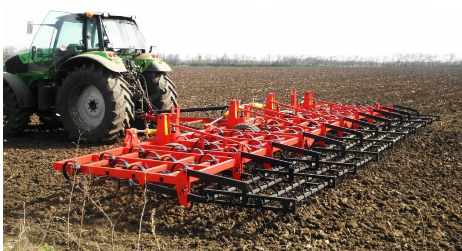
Рисунок 1.6 – Культиватор беззцепний для суцільного обробітку ґрунту КШУ-12-01
