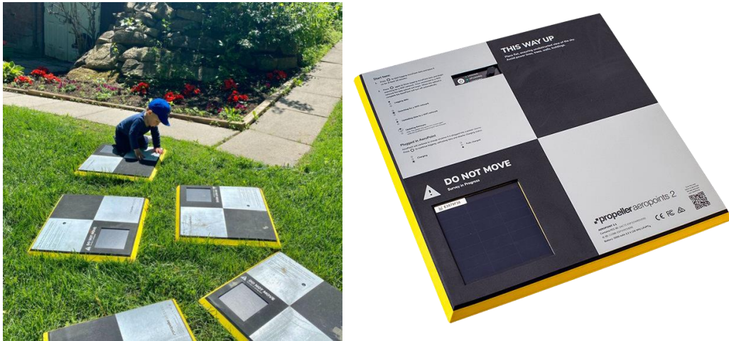
Рис.2.7. AeroPoints. Смарт – наземна контрольна точка з підтримкою функції базової ГНСС- станції.
