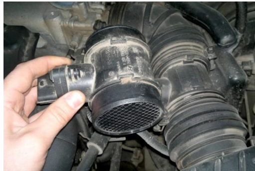
Рисунок 3.1 – Розміщення та положення давача кількості повітря у впускній магістралі.
