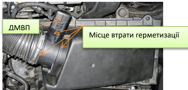
Рисунок 1.7 – Місця розгерметизації впускної магістралі.
