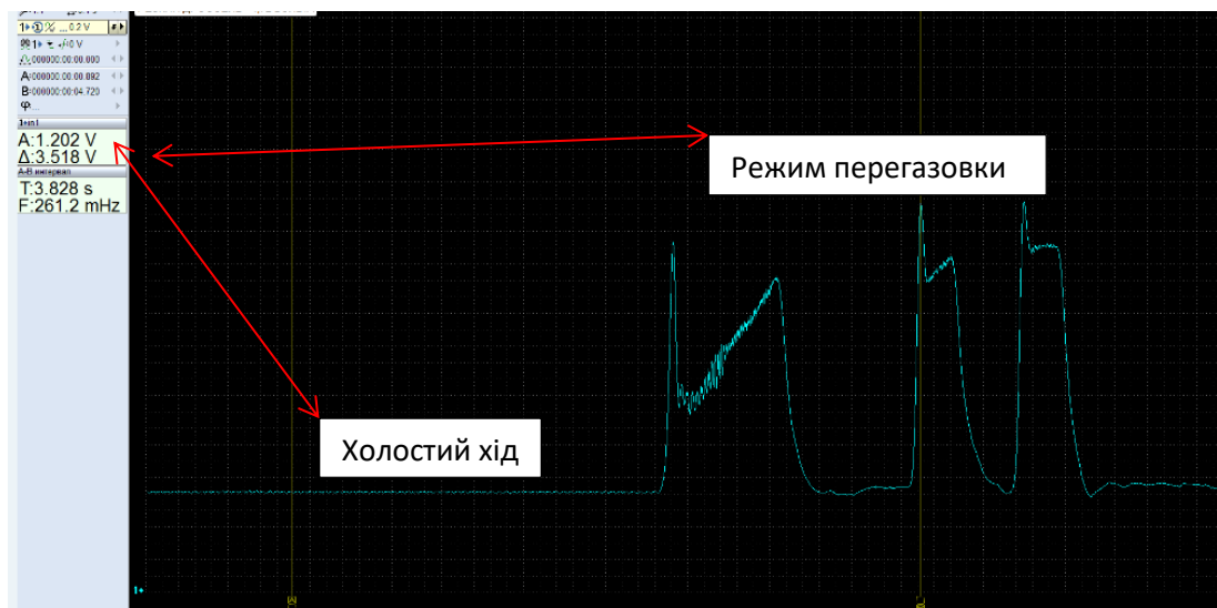
Рисунок 3.6 – Форма електричних імпульсів ДМВП на холостому ходу інжекторного двигуна.
