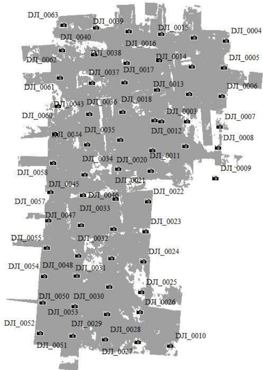
Рис.3.2. Схема розміщення центрів проєкцій аерознімків та 3D хмара точок на територію дослідження.
