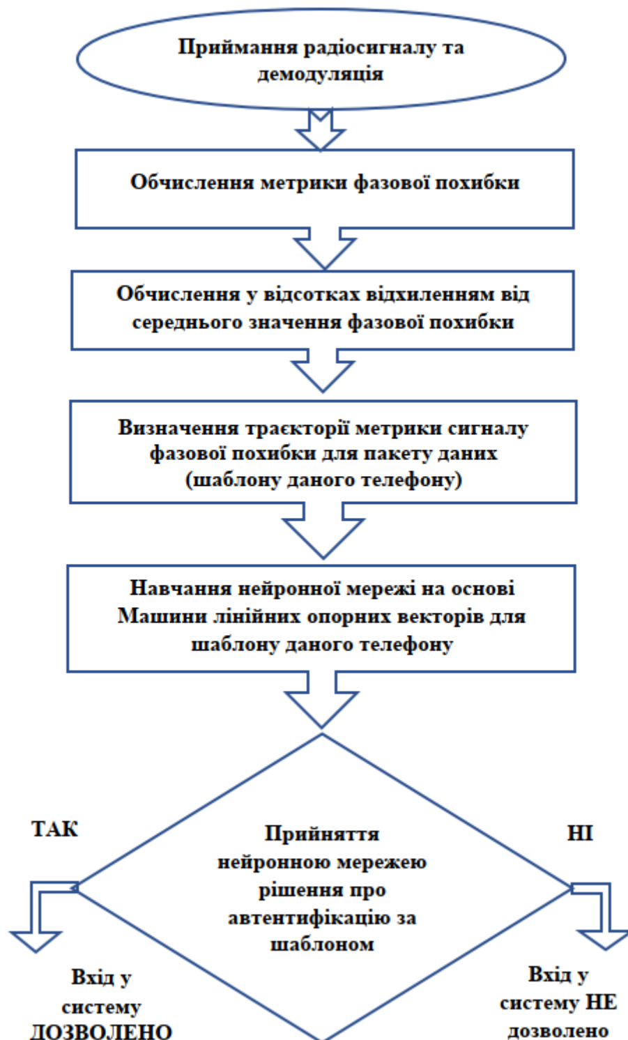
Рис. 3.8. Алгоритм створення шаблону для автентифікації мобільного телефону (електронного пристрою) без використання автентифікаторів IMSI та IMEI конкретного мобільного телефону.
