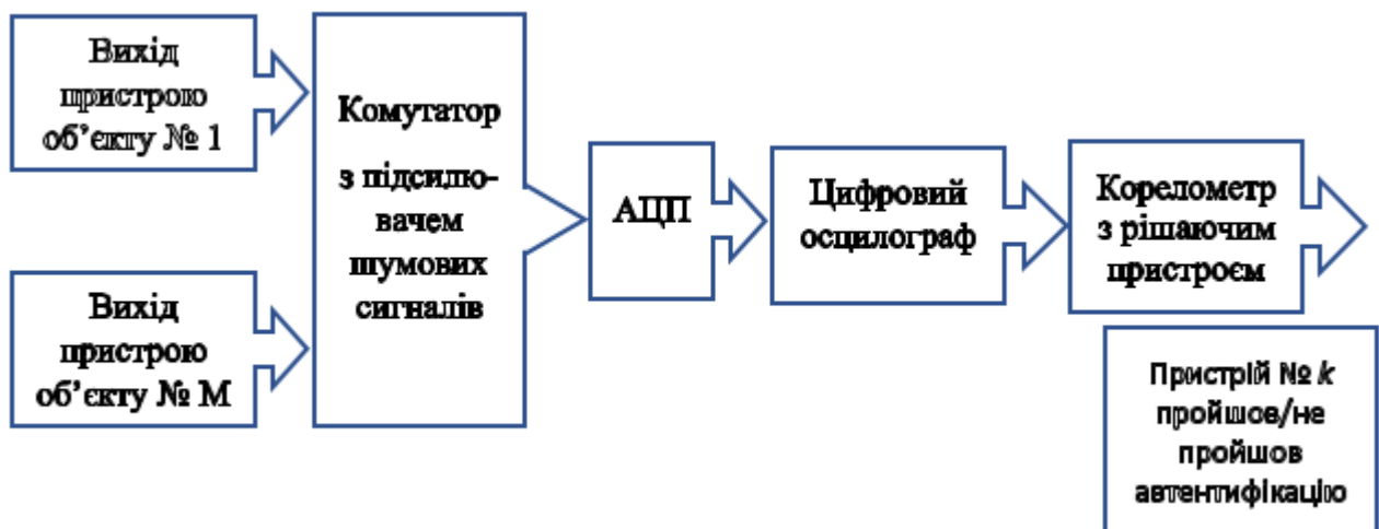
Рис. 3.2. Структурна схема інформаційної системи автентифікації електронних пристроїв об'єктів АПК за їх шумовими характеристиками.
